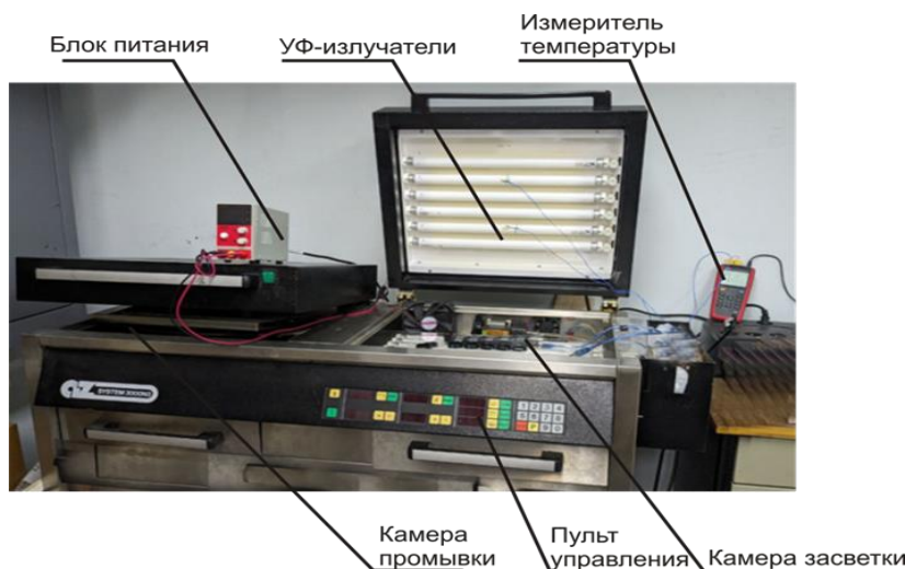
Рис. 4. Промышленная установка AZ3000N3
