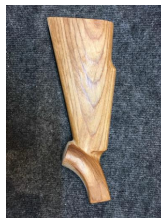
Рис. 4. Заготовки приклада (клееная слоистая древесина со специальной конструкцией) после механической обработки
