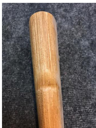
Рис. 3. Клееная слоистая древесина со специальной конструкцией (с продольными осями симметрии)
