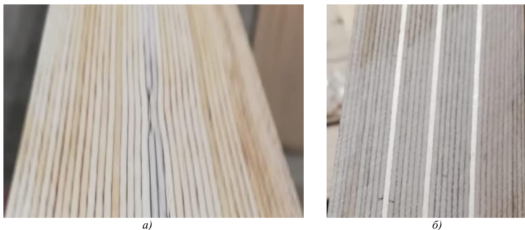
Рис. 2. Клееная слоистая древесина со специальной конструкцией: а – фанерная плита марки ПФО-Х; б – фанерная плита марки ПФ-Б
