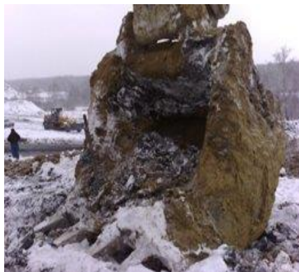
Рис. 1. Ковш экскаватора с примерзшим к нему грунтом
