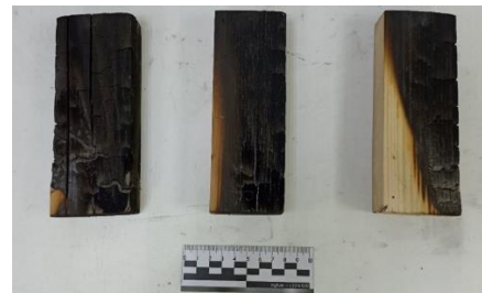
Образцы древесины № 18–20, обработанные ОС № 3
