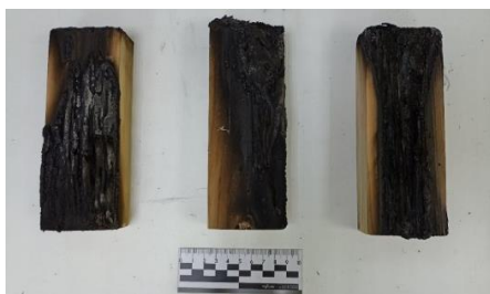
Образцы древесины № 12–14, обработанные ОС № 1
