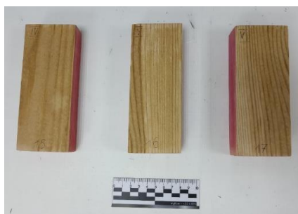
Образцы древесины № 15–17, обработанные ОС № 2
