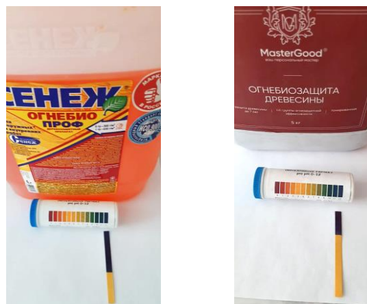
Рис. 11. Определение водородного показателя ОС (слева – фирмы «Сенеж», справа – "MasterGood")
