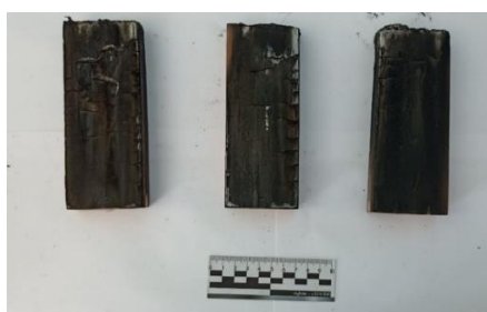
Образцы древесины № 4–6, обработанные ОС № 2
