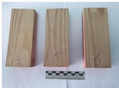
Образцы древесины № 4–6, обработанные ОС № 2
