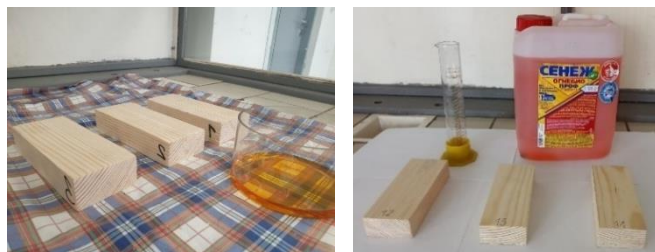
Рис. 3. Зафиксированы номера брусков и используемый огнезащитный состав
