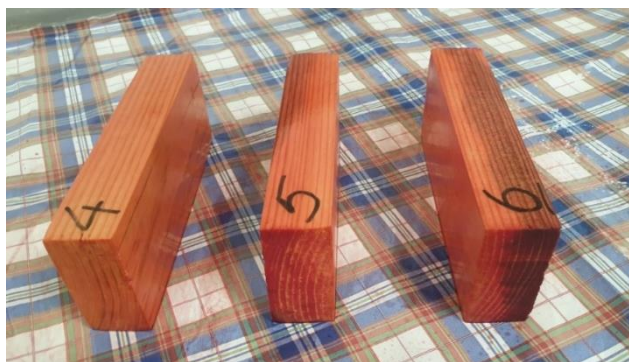
Рис. 6. Деревянные бруски № 4–6 с нанесённым огнезащитным составом от "MasterGood"
