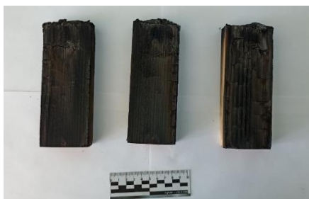
Образцы древесины № 1–3, обработанные ОС № 1
