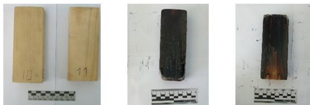
Рис. 16. Образцы древесины № 10–11, необработанные ОС (слева – до огневого испытания, справа – после)
