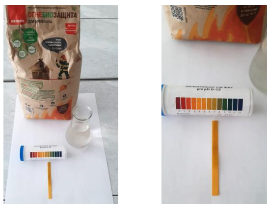
Рис. 12. Определение водородного показателя ОС фирмы "Neomid"
