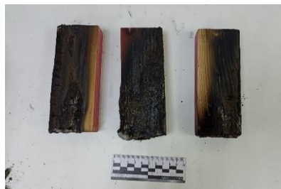
Образцы древесины № 15–17, обработанные ОС № 2
