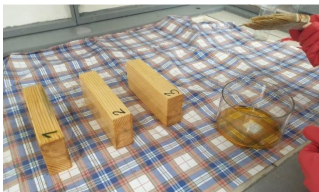
Рис. 4. Промежуточная сушка брусков № 1–3 с огнезащитным составом от фирмы «Сенеж»
