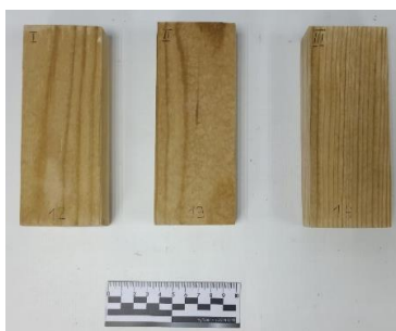
Образцы древесины № 12–14, обработанные ОС № 1
