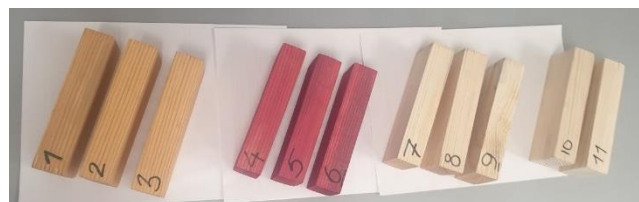
Рис. 8. Общий вид деревянных образцов, обработанных огнезащитными составами (№ 1–9) и неподвергавшихся обработке огнезащитными составами (№ 10, 11)
