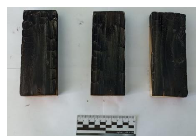
Образцы древесины № 7–9, обработанные ОС № 3
