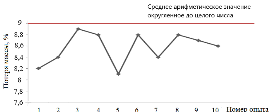
Рис. 3. График значений потери массы образцов в % после воздействия пламени
