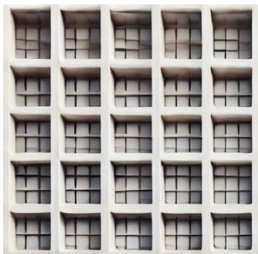
Рис. 6. Полученное изделие с вафельной конструкцией из полимерного композиционного материала ROEHM R-50
