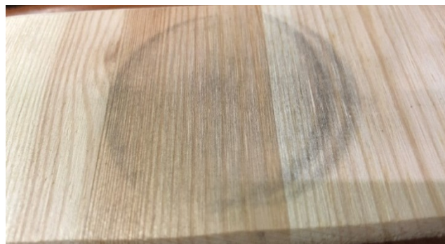
Рис. 6. Отпечаток на древесине сосны после взаимодействия с накладкой из «черной» резины
