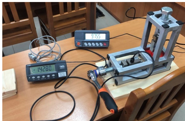
Рис. 9. Установка для определения коэффициента трения
