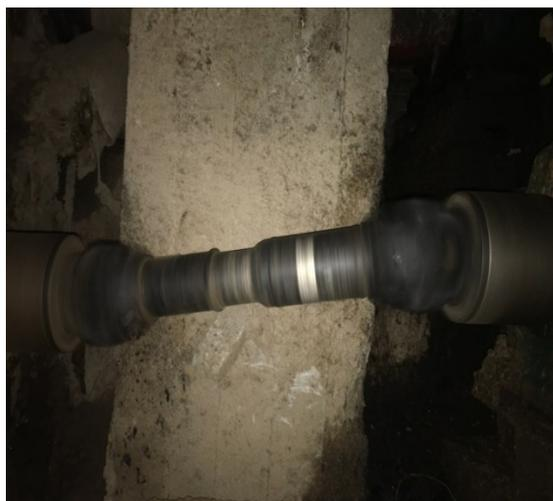
Рис. 7. Фото карданного вала в вертикальной плоскости
