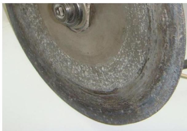
Рис. 4. Взаимодействие размягченного металла с ЭИ
