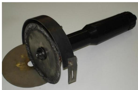
Рис. 2. Ручная машина электроконтактной резки
