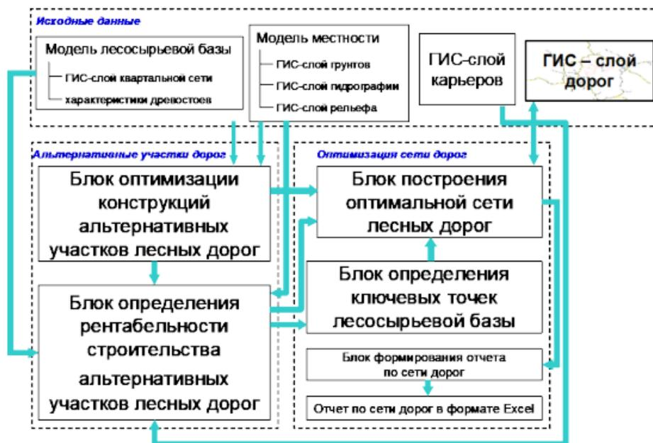
Рис. 2. Схема структуры информационно-вычислительной системы
