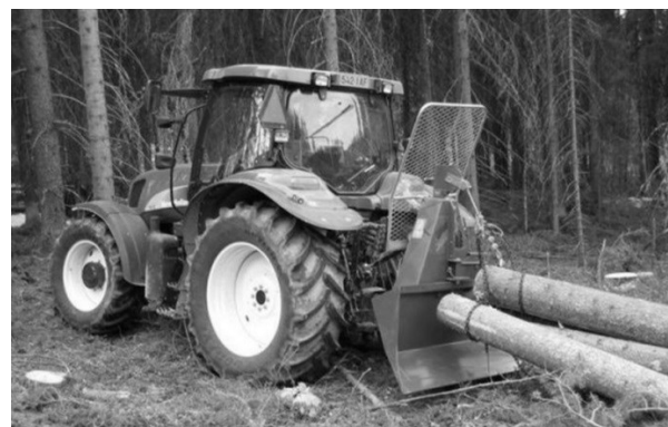
Рис. 2. Трактор с торцевым щитом и лебедкой типа «TAJFUN»
