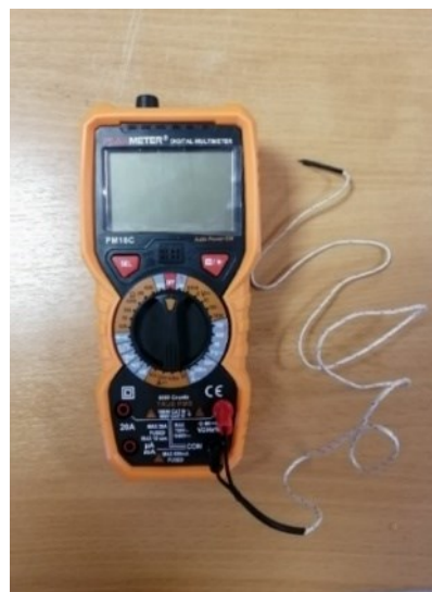
Рис. 2. Мультиметр цифровой PeakMeter 8229
