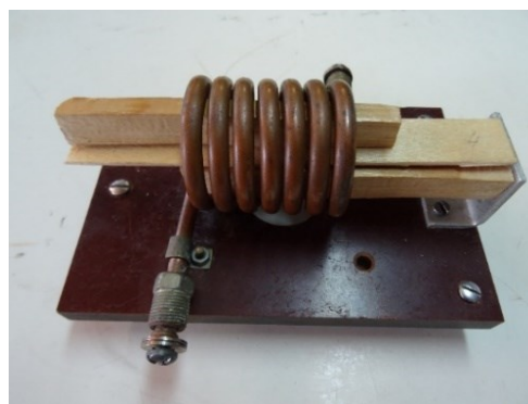
Рис. 3. Приспособление для склеивания образцов шпона в индукторе
