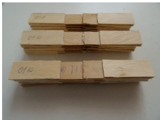
Рис. 5. Образцы шпона для испытаний на сдвиг
