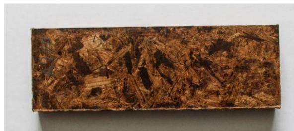
Рис. 2. Композитный материал из гидролизованной древесины березы, полученный без добавления связующих веществ
