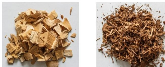
Рис. 1. Исходная (слева) и гидролизованная (справа) древесина березы
