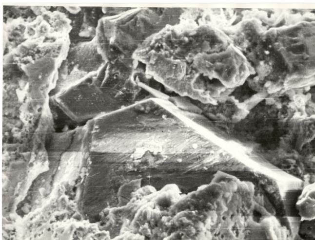
Рис. 1. Поверхность нового (до работы) алмазного круга АС6 125/100 М1 -100%
