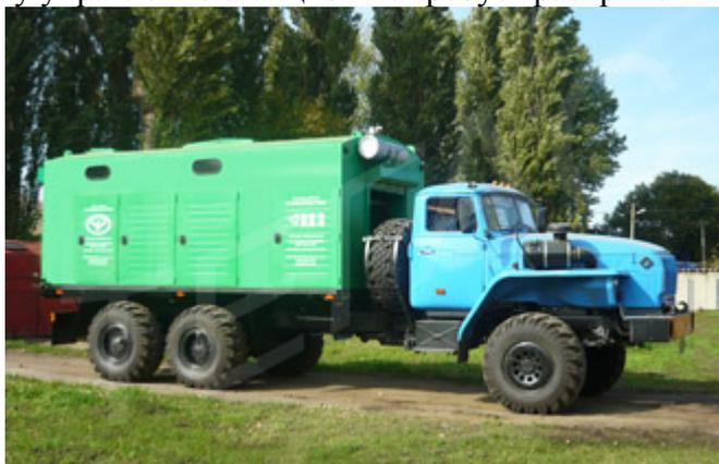
Рис. 2. Передвижная компрессорная станция
