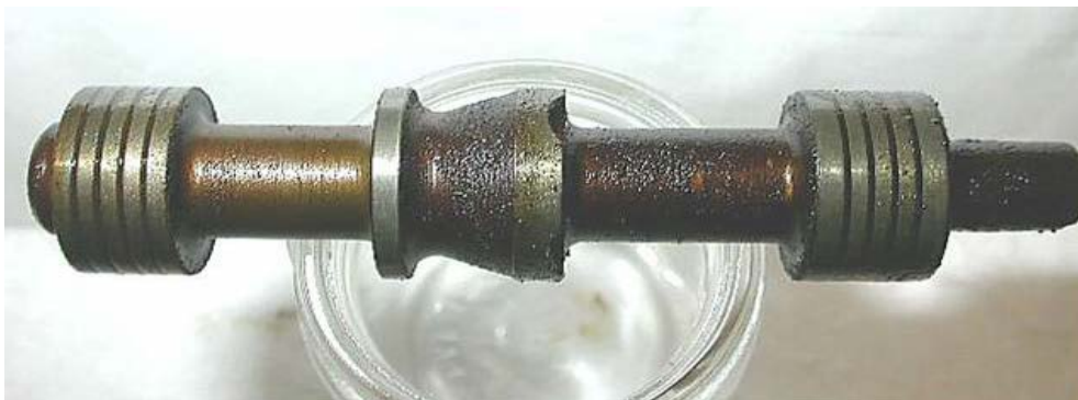
Рис. 1 – Лаковые отложения на золотнике – следствие низкой термической стабильности
