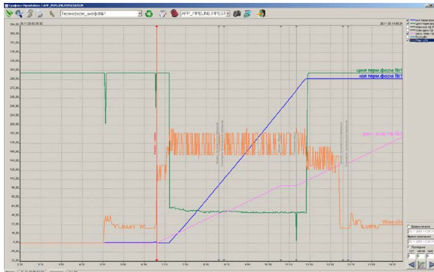
Рис.9. Работа автоматической линии формовки панелей с измерением потребляемой мощности. (2009 г.)
