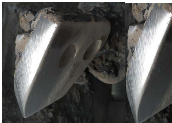
Рис.3. Характер износа поверхности лопатки
