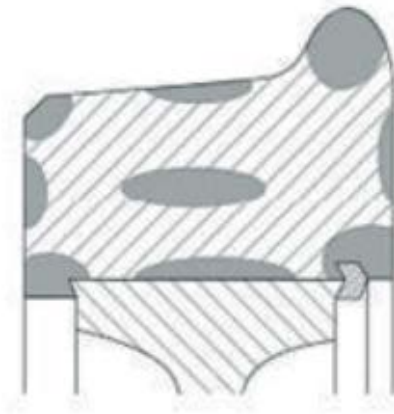
Рис. 1. Выделены места усталостного разрушения бандажей, которые могут послужить началом усталостного изнашивания.
