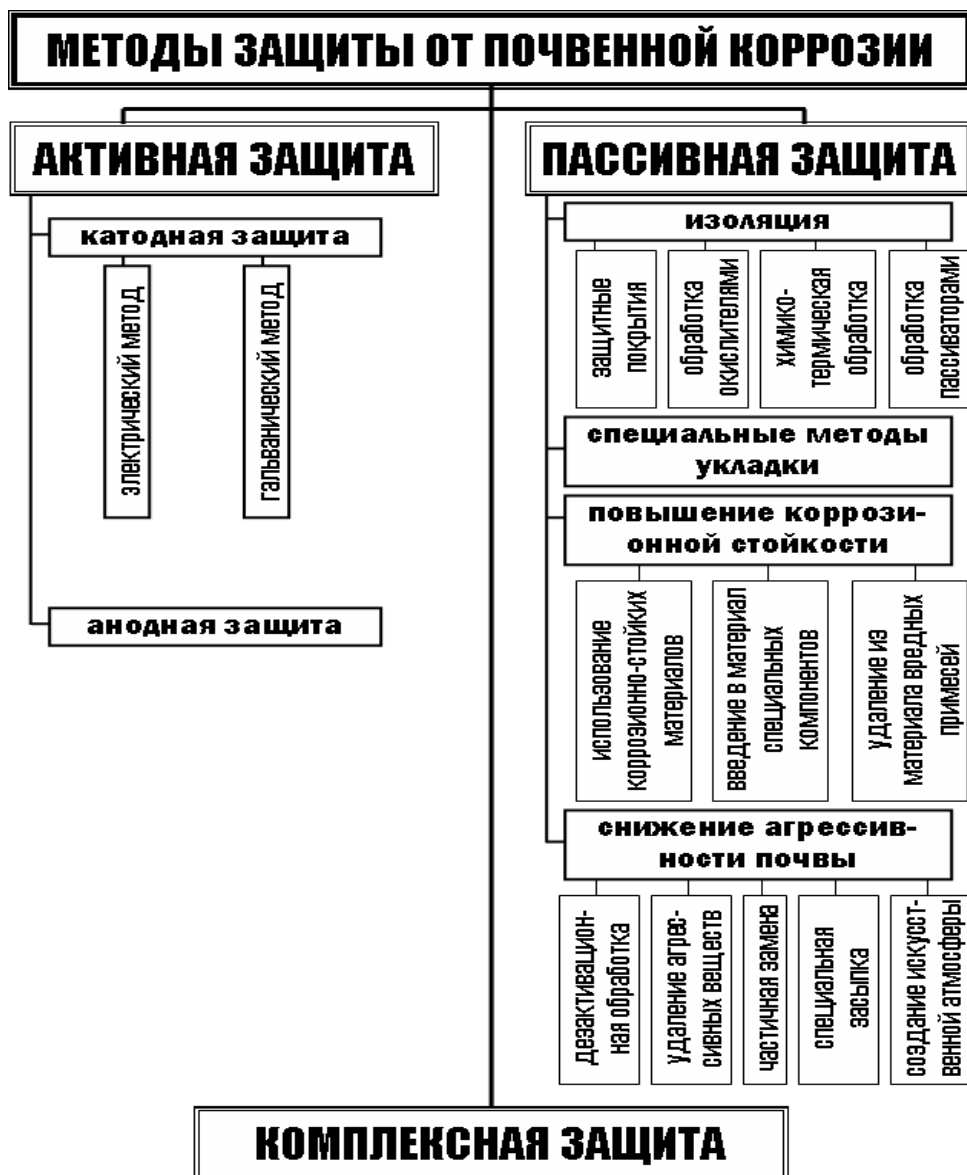
Рис. 1. Обобщённая классификация методов защиты от почвенной коррозии
