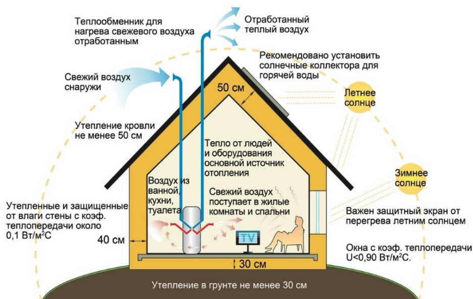
Рис. 2. Схема функционирования «Пассивного дома» [3]
