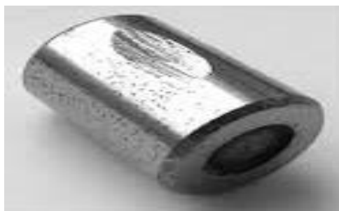
Рис. 2. Износ ролика при трении о вал (лунки сверху)
