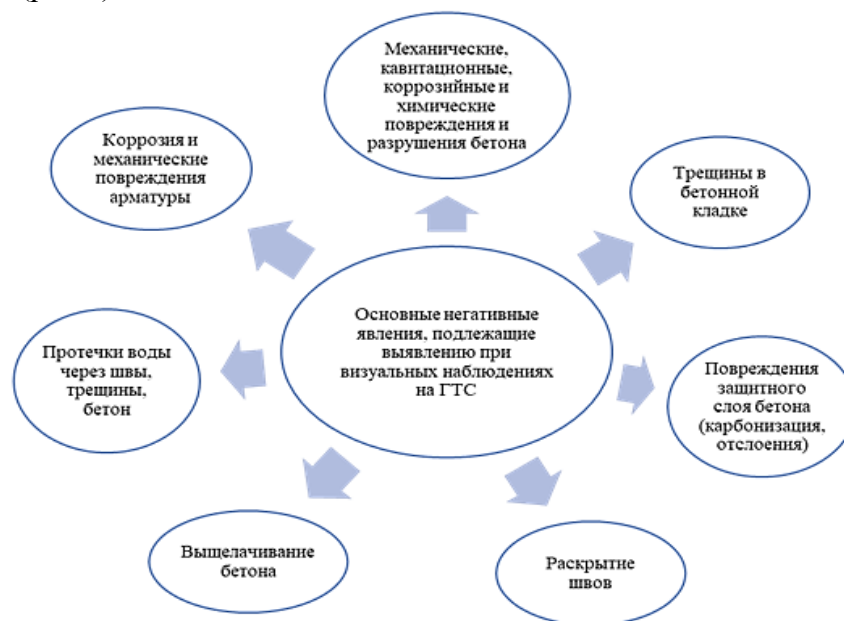
Рис.1. Негативные явления, подлежащие выявлению при визуальных наблюдениях на ГТС
