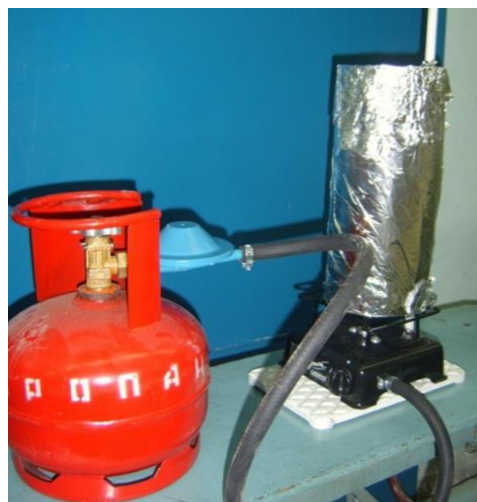
Рис. 1. Экспериментальная лабораторная установка для определения огнезащитной эффективности антипиренов
