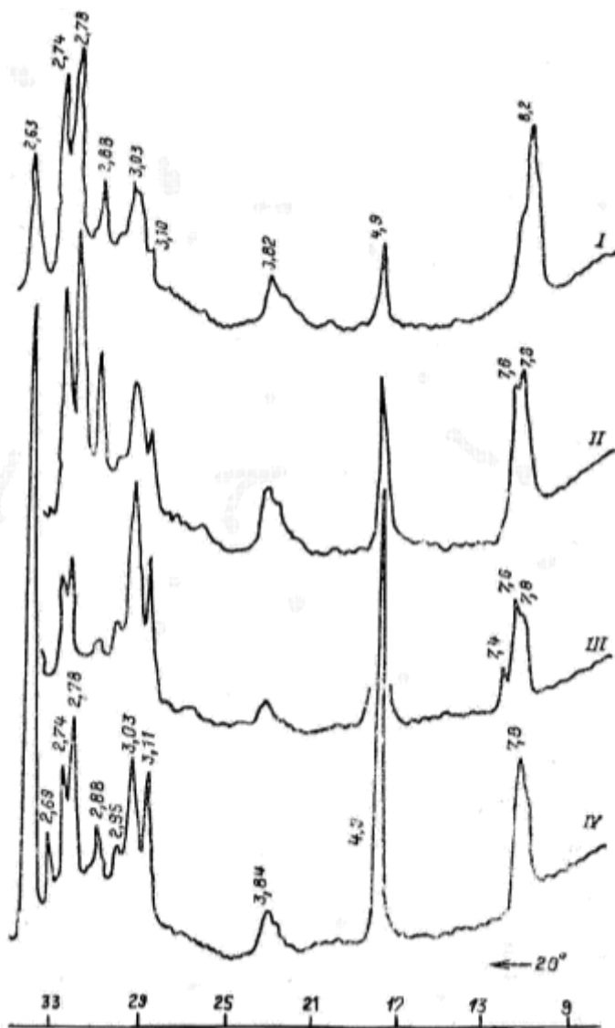
Рис. 2.18. Рентгенограммы цементного камня из клинкера I–IV через 1 год твердения (значения d/n указаны в Å)
